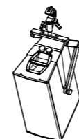
使用 Z5383 VP 安装支架 Z5010 TV 含支杆的托板 Z5012 支杆构架 安装 V7P/V10P 音箱
